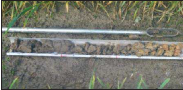
Illustration 52 : Exemple de carottage sur une profondeur de 120 cm
